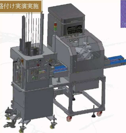
小型容器供給機 ▶ 飯盛り達人U成形ユニット KYK MMU
